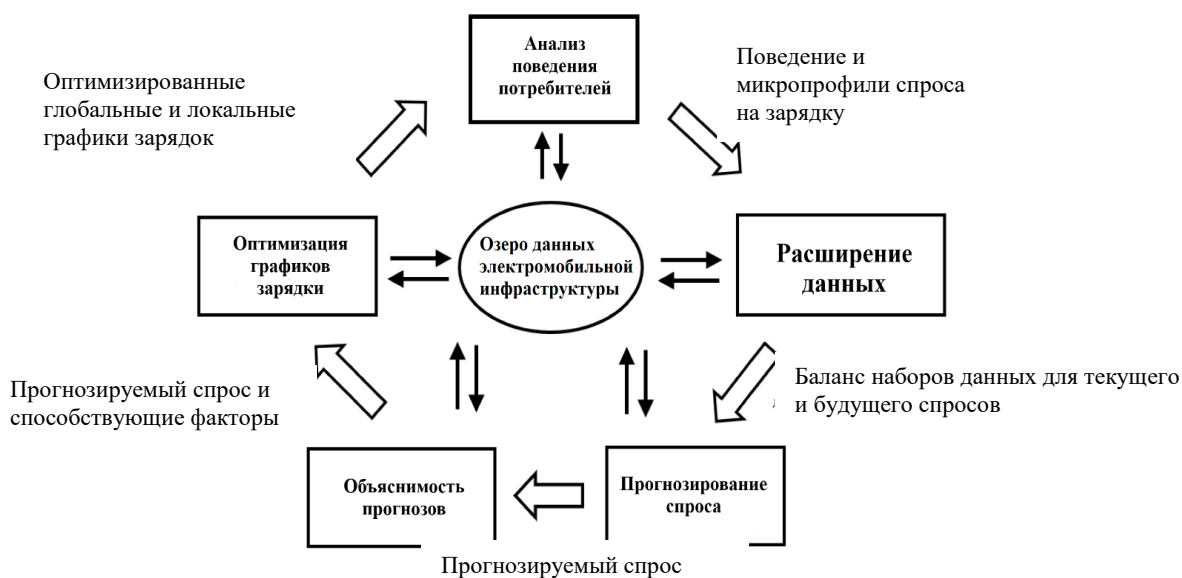
Рис. 2. Предлагаемая структура ИИ для инфраструктуры электромобилей
