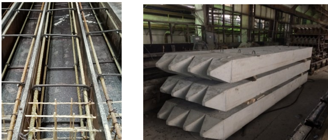
Рис. 1. Сваи железобетонные квадратного сечения на АСК
