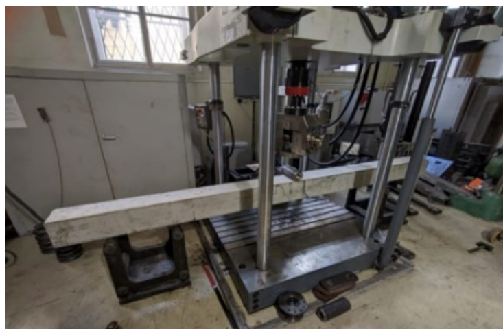
Рис. 2. Стенд для испытаний свай на трехточечный изгиб
