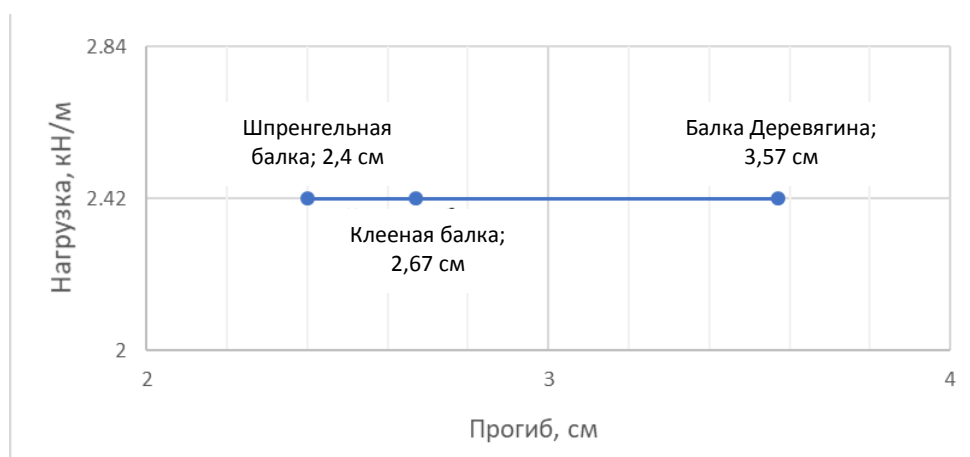
Рис. 4. График деформации балок
