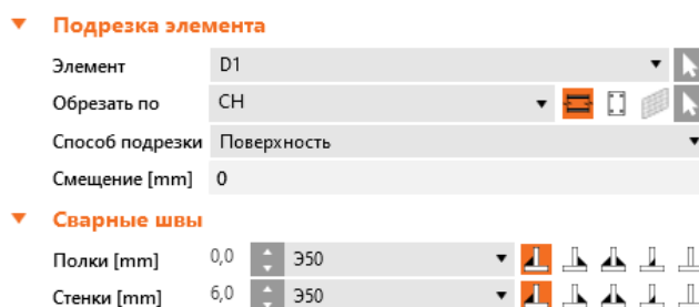
Рис. 7. Характеристики сварного соединения «CH» и «D1»
