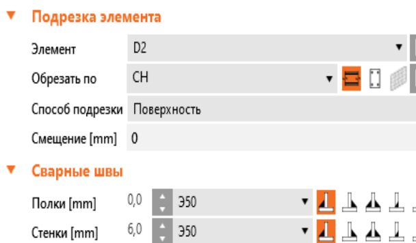
Рис. 7. Характеристики сварного соединения «CH» и «D1»
