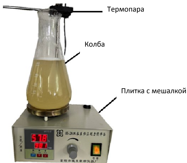
Рис. 2. Установка для проведения синтеза метионата кальция
