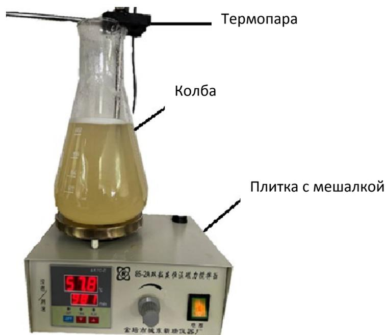
Рис. 2. Установка для проведения синтеза метионата кальция
