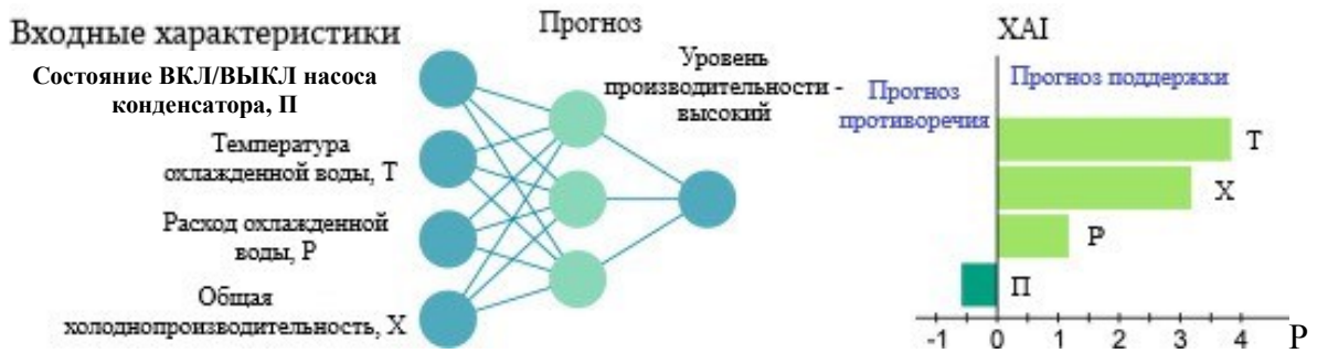
Рис. 3. Пример модели классификатора с XAI для оценки эффективности энергопотребления в здании
