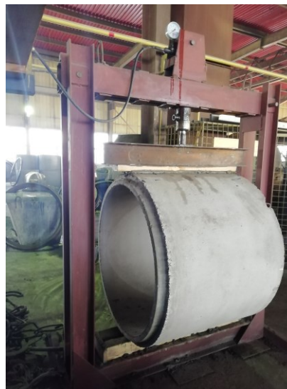
Рис. 4. Испытание кольца колодца на стенде
