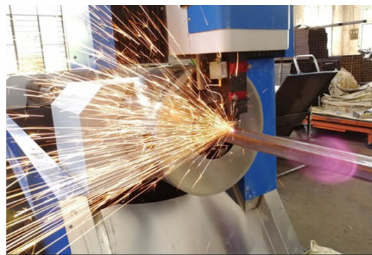
Рис. 2. Лазерная резка труб
