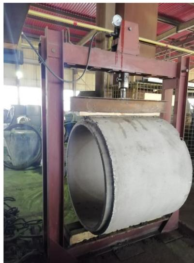
Рис. 4. Испытание кольца колодца на стенде
