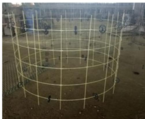
Рис. 2. Сетка из стеклокомпозитной арматуры
