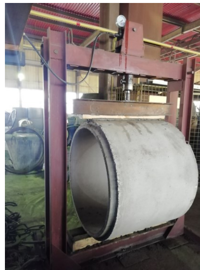
Рис. 4. Испытание кольца колодца на стенде
