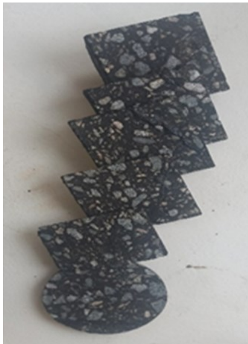
Рис. 4. Внешний вид образца после послойного разрезания керна, взятого в месте стыка для контроля расположения ленты
