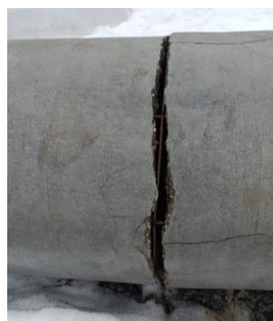
Рис. 5. Неправильное складирование труб и последствия
