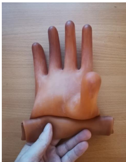
Рис. 1. Проверка диэлектрических перчаток скручиванием
