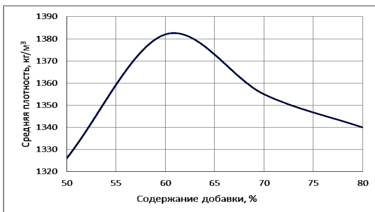
Рис. 5. Зависимость средней плотности фосфогипсовых образцов от содержания алюмосиликатной добавки
