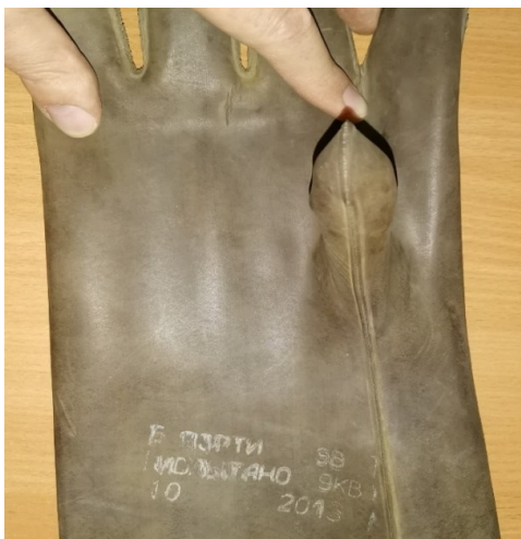
Рис. 6. Шовные (штанцованные) диэлектрические перчатки
