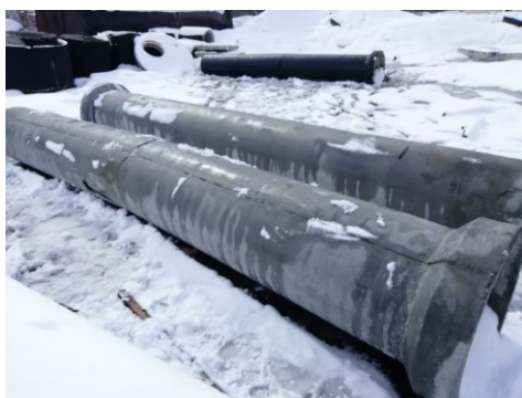
Рис. 5. Неправильное складирование труб и последствия
