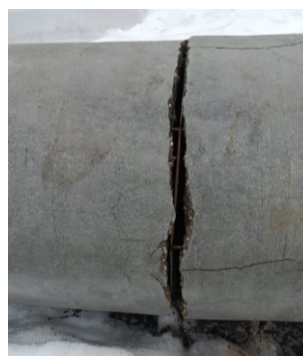
Рис. 5. Неправильное складирование труб и последствия
