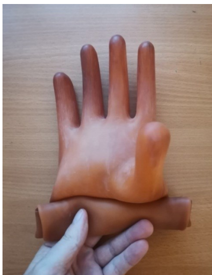
Рис. 1. Проверка диэлектрических перчаток скручиванием
