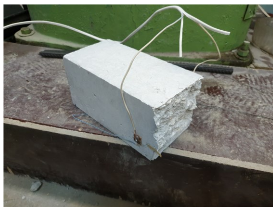
Рис. 2. Образец после разрушения
