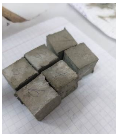
Рис. 2. Внешний вид золоцементного искусственного камня: а – до разрушения при испытании; б – после разрушения
