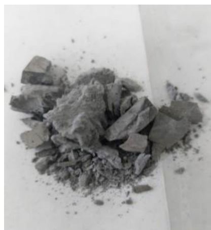
Рис. 2. Внешний вид золоцементного искусственного камня: а – до разрушения при испытании; б – после разрушения
