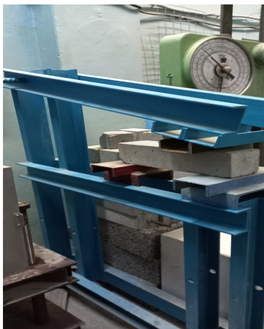
Рис. 1. Общий вид ударной установки с положением образца-призмы для испытания на поперечный удар
