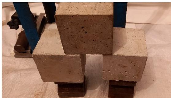
Рис. 1. Опытные образцы-кубы
