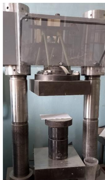
Рис. 3. Гидравлический пресс для испытания на статическое сжатие
