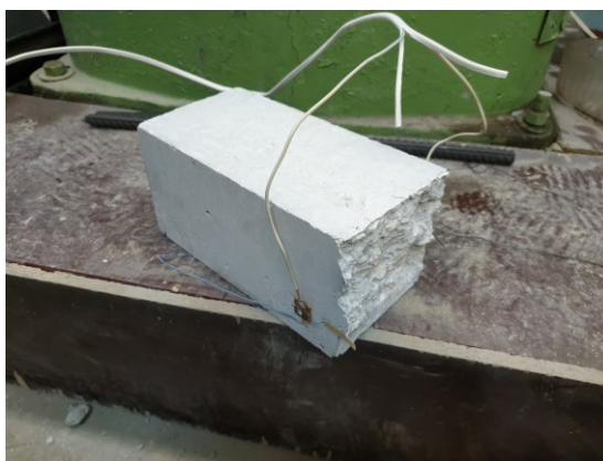
Рис. 2. Образец после разрушения
