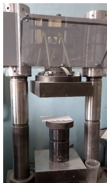
Рис. 3. Гидравлический пресс для испытания на статическое сжатие
