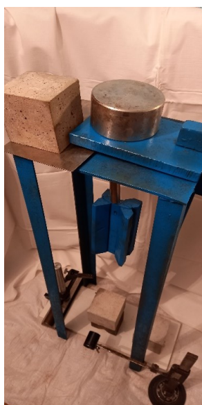
Рис. 2. Ударная установка с образцом-кубом для испытания на ударное сжатие
