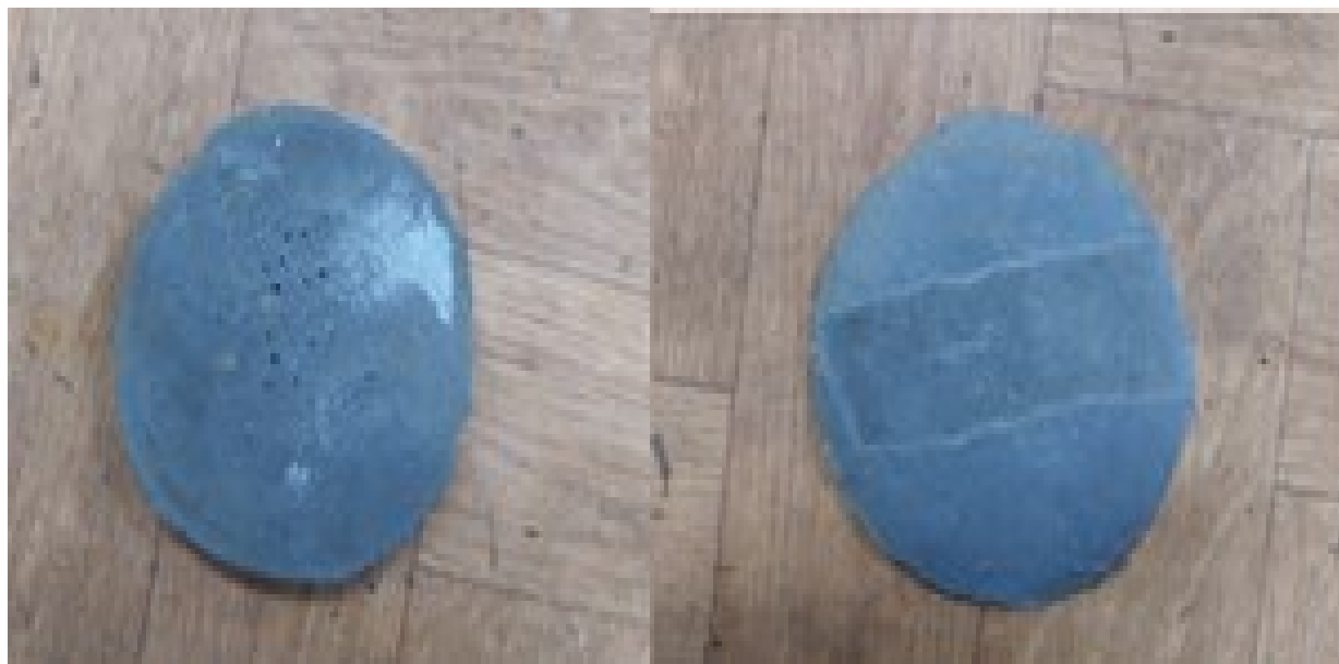
Рис. 3. Внешний вид и поверхность образцов золоцементной композиции после испытаний
