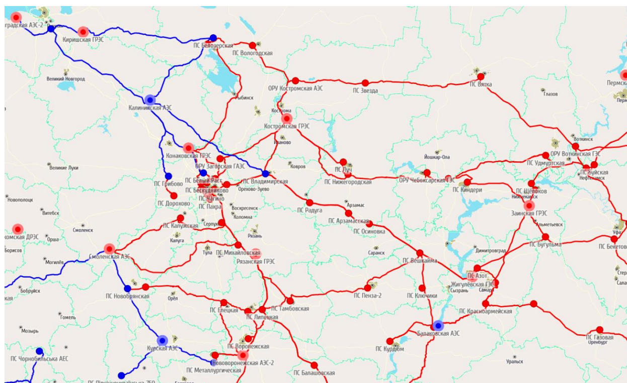
Рис. 1. Карта европейской части России с нанесенными на нее линиями напряжением 750 кВ (синие) и 500 кВ (красные). По данным сайта «Схемы ЛЭП и электроснабжения России» ( https://frexosm.ru/power/ )
