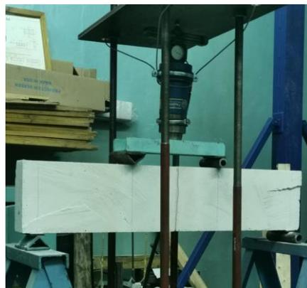
Рис. 3. Общий вид перемычки, помещенной в испытательную установку
