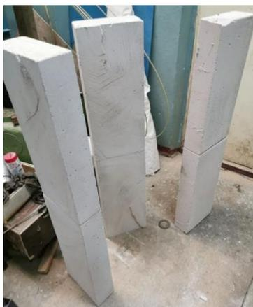
Рис. 1. Твердение образцов клееных газобетонных перемычек
