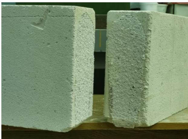
Рис. 4. Типичный вид торцов блоков после разрушения перемычки
