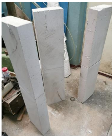
Рис. 1. Твердение образцов клееных газобетонных перемычек
