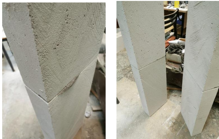
Рис. 2. Процесс корректировки положения заготовок и твердения перемычек
