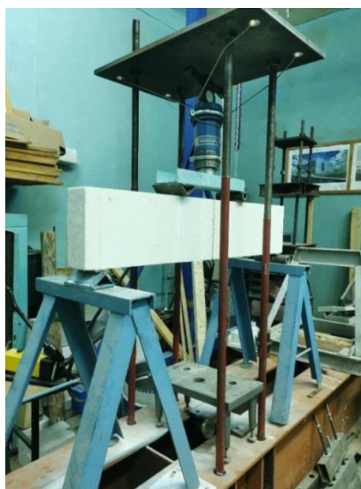
Рис. 3. Общий вид перемычки, помещенной в испытательную установку
