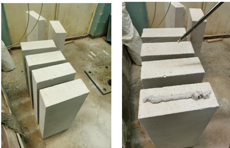
Рис. 1. Процесс нанесения клей-пены на газобетонные заготовки
