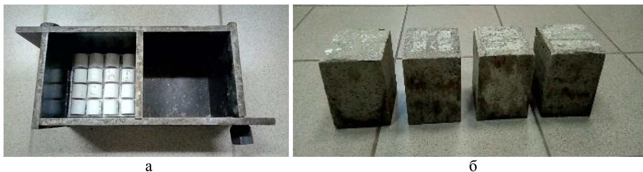
Рис. 4. Модельные образцы – кубики, матрица которых равномерно заполнена дискретными пластиковыми трубками: а – на этапе формования; б – готовые образцы
