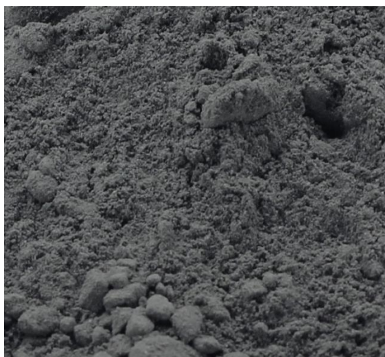
Рис. 1. Золошлаковая смесь Каширской тепловой электростанции
