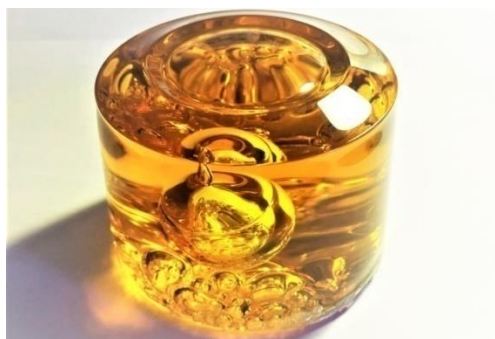
Рис. 2. Образец полимеризованного нерасширяющегося двухкомпонентного инъекционного полиуретанового состава
