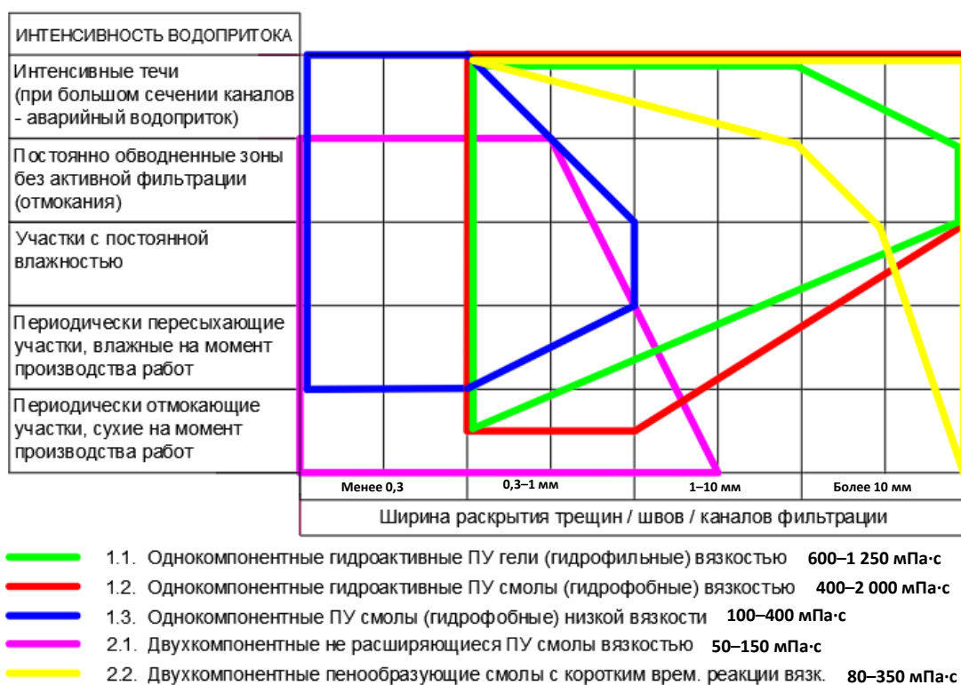
Рис. 3. Графическое отображение областей применения групп материалов в зависимости от интенсивности водопритока и ширины раскрытия дефектов: ПУ – полиуретановые
