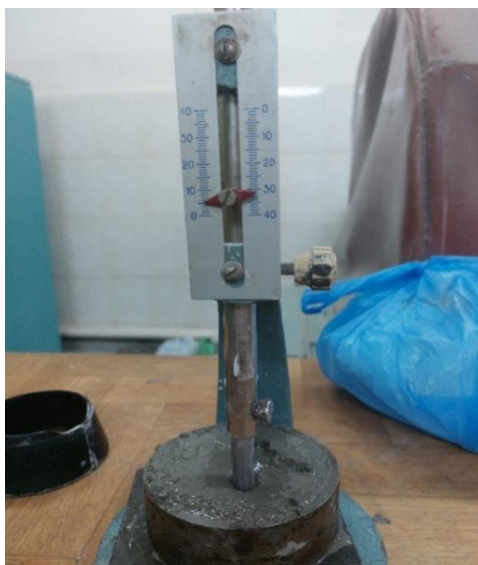
Рис. 3. Определение нормальной густоты цементного теста
