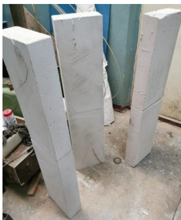
Рис. 1. Твердение образцов клееных газобетонных перемычек
