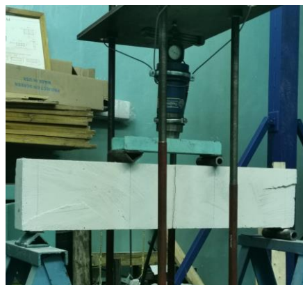
Рис. 3. Общий вид перемычки, помещенной в испытательную установку
