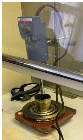
Рис.2. Распределение компонентов в битумной смеси с помощью смесителя IKA Ultra-Turrah T25 digital
