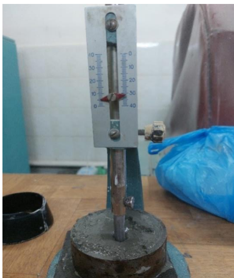
Рис. 3. Определение нормальной густоты цементного теста
