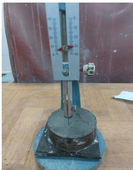
Рис. 5. Определение сроков схватывания цементного теста с добавкой АСК ЗШС
