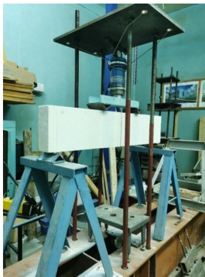
Рис. 3. Общий вид перемычки, помещенной в испытательную установку
