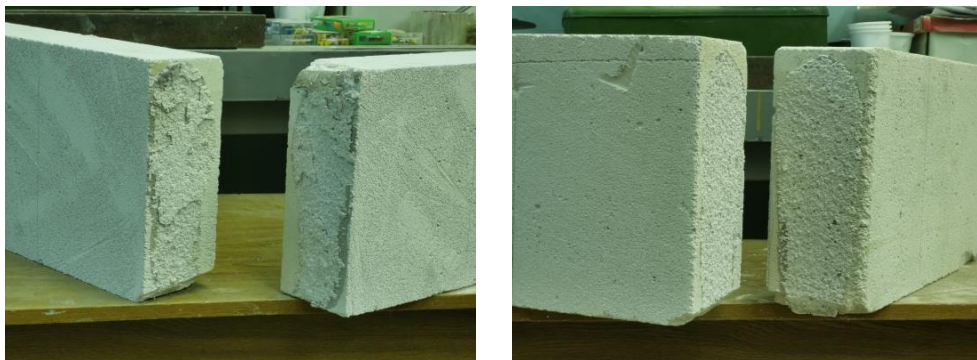
Рис. 4. Типичный характер разрушения исследуемых перемычек
