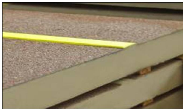
Рис. 1. Железнодорожные плиты с обнаженным крупным заполнителем
