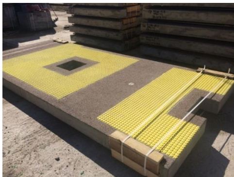
Рис. 1. Железнодорожные плиты с обнаженным крупным заполнителем
