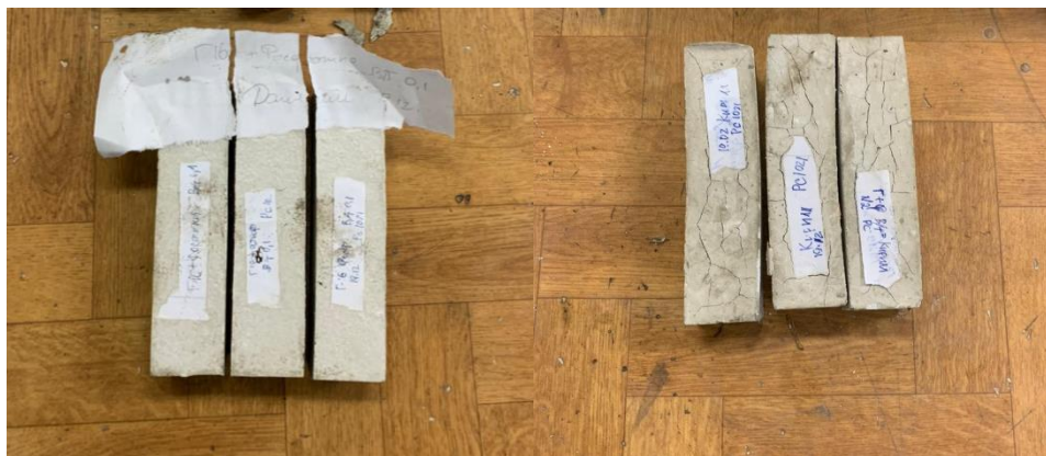
Рис. 3. Образцы-балочки на основе фосфогипсовых смесей
