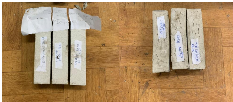
Рис. 3. Образцы-балочки на основе фосфогипсовых смесей
