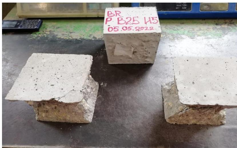
Рис. 2. Образцы, испытанные на прочность после нагрева
