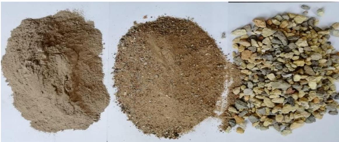
Рис. 1. Инертные материалы для изготовления жаростойкого бетона.
