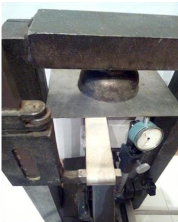
Рис. 1. Устройство для испытания на деформацию ползучести (фото автора)
