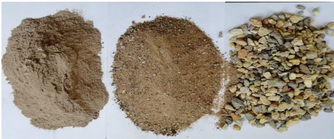
Рис. 1. Инертные материалы для изготовления жаростойкого бетона. Слева направо: шамот молотый, отсев шамота 0–5 мм, шамотный щебень 5–20 мм
