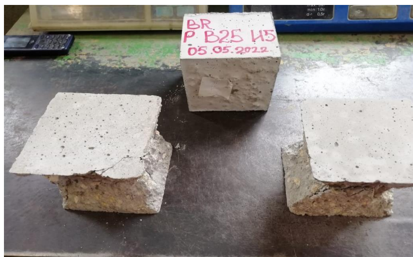
Рис. 2. Образцы, испытанные на прочность после нагрева
