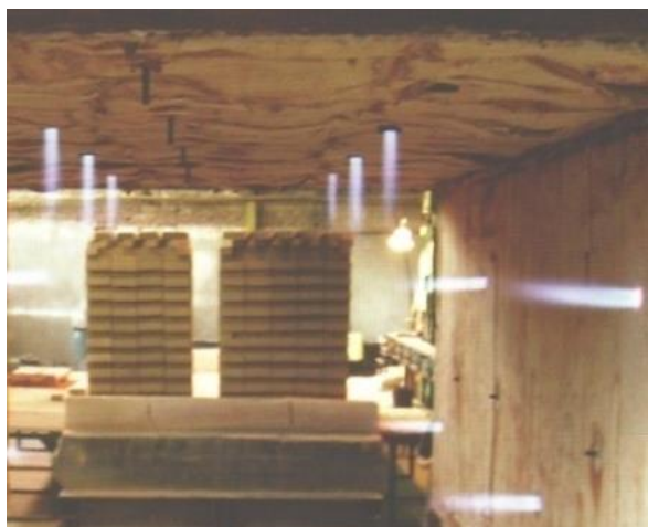
Рис. 3. Факельная печь для обжига кирпича
