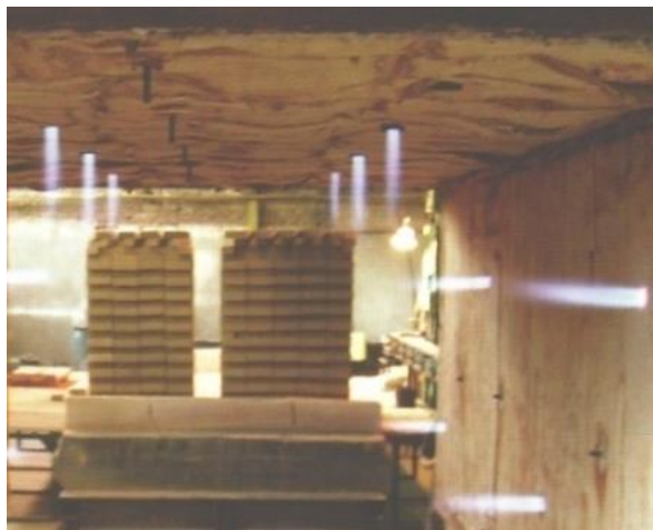
Рис. 3. Факельная печь для обжига кирпича
