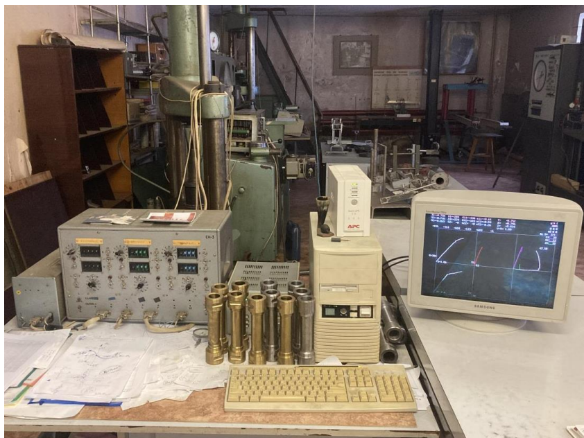
Рис. 1. Автоматизированный испытательный комплекс СН-ЭВМ
