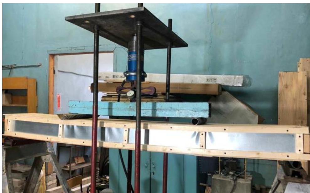
Рис. 5. Характер потери устойчивости стенки панели
