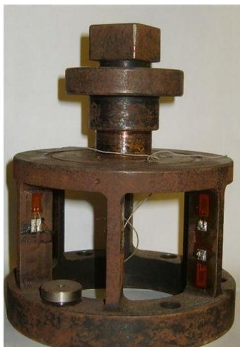
Рис. 4. Силопреобразователь
