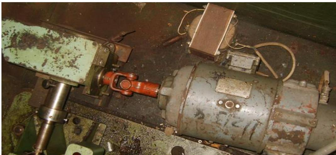
Рис. 2. Двигатель постоянного тока ПБСТ
