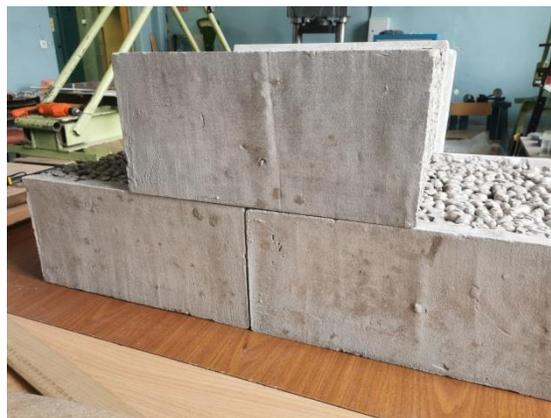
Рис. 2. Фрагмент кладки стены со стороны внутреннего бетонного слоя
