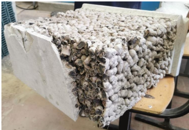
Рис. 3. Характер разрушения блока при действии нагрузки на внутренние углы через штамп размерами 140×197 мм
