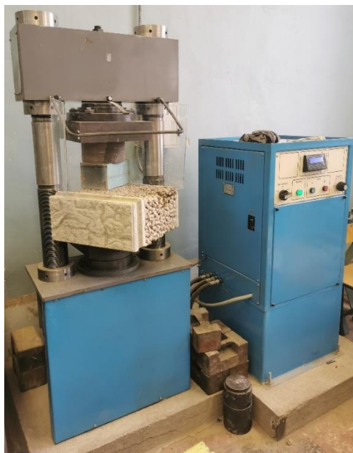
Рис. 2. Общий вид испытательного пресса с помещенным в него образцом № 1
