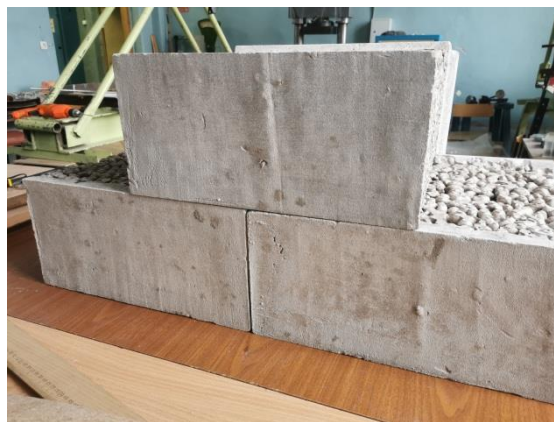
Рис. 2. Фрагмент кладки стены со стороны внутреннего бетонного слоя
