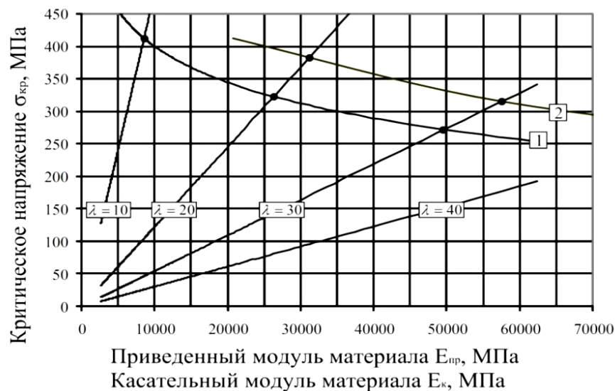
Рис. 3. Критическое напряжение при расчете стержней по теориям Энгессера и Кармана ( \alpha = 15^\circ )
