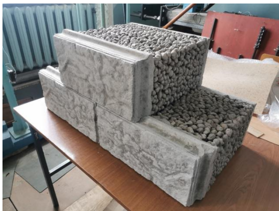
Рис. 1. Фрагмент кладки стены со стороны лицевого бетонного слоя
