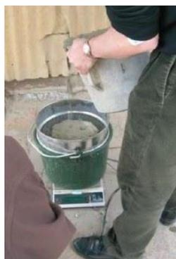
Рис. 5. Определение сопротивления сегрегации с помощью сита
