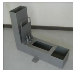
Рис. 4. Определение проходимости с помощью L-образного ящика
