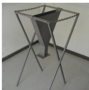
Рис. 3. Определение  $T_v$  с помощью V-образной воронки
