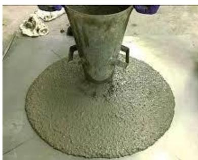
Рис. 2. Определение расплыва конуса
