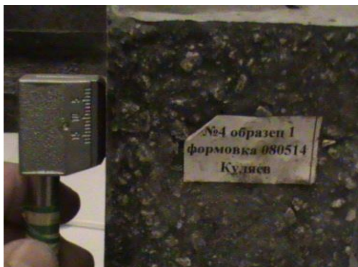
Рис. 2. Сканирование гомогенности внутренней структуры композита с помощью трансдюсера генератора УДМ в процессе твердения бетона
