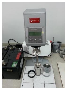
Рис. 6. Определение предела текучести и пластической вязкости с помощью лопатки, соединенной с ротационным реометром
