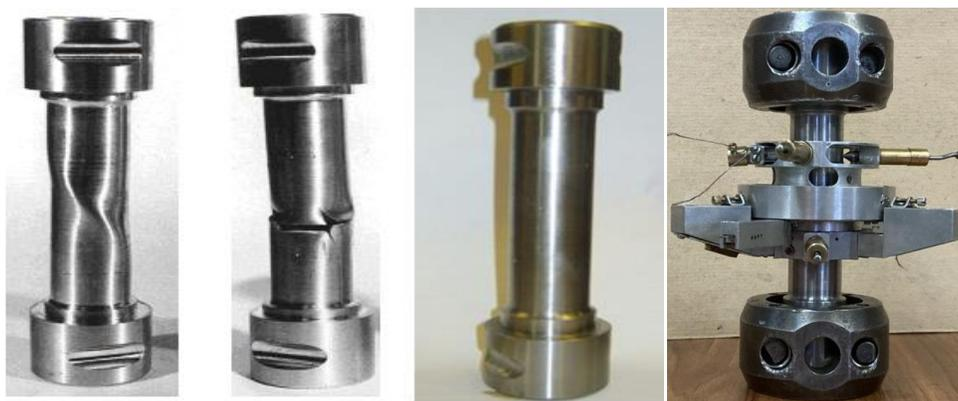
Рис. 1. Модернизированный измеритель деформации
