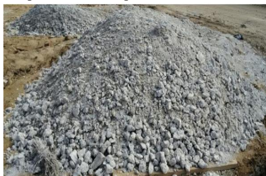
Рис. 2. Щебень после вторичного дробления
