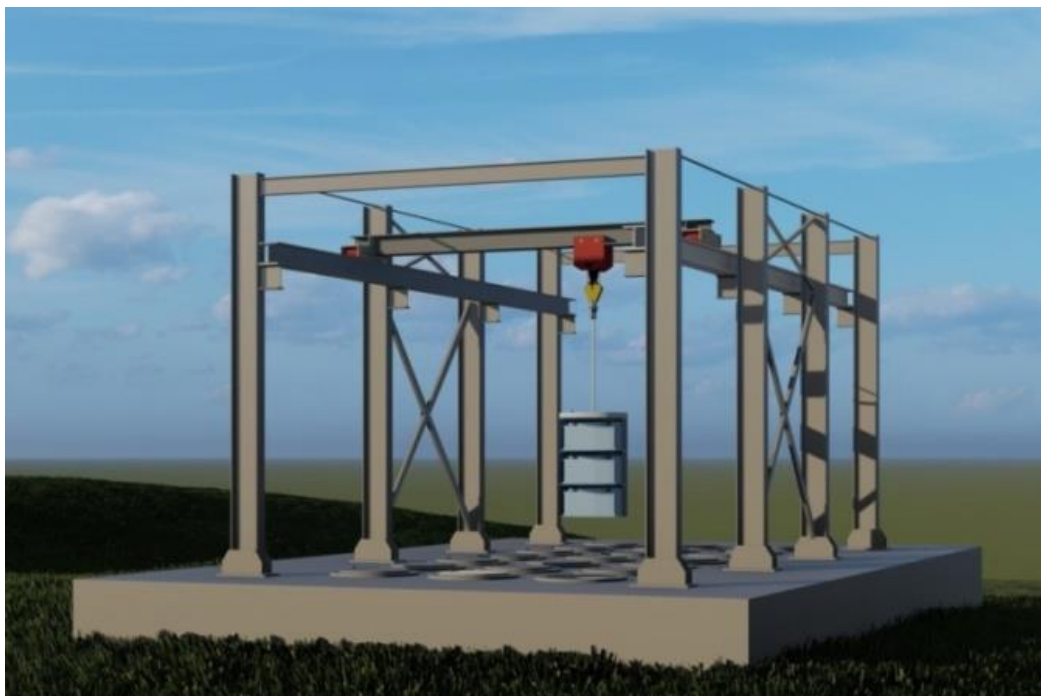
Рис. 4. Крановая установка, используемая для обслуживания емкостей энергонакопителей
