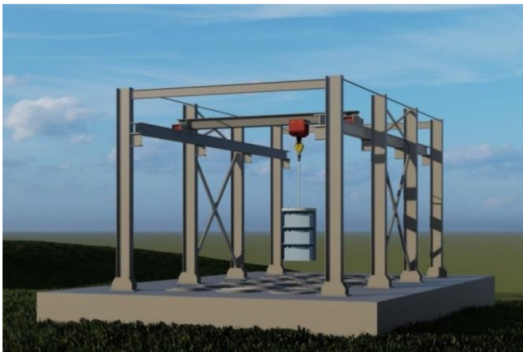
Рис. 4. Крановая установка, используемая для обслуживания емкостей энергонакопителей
