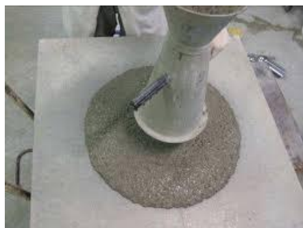
Рис. 2. Определение подвижности СУБ путем измерения величины расплыва
