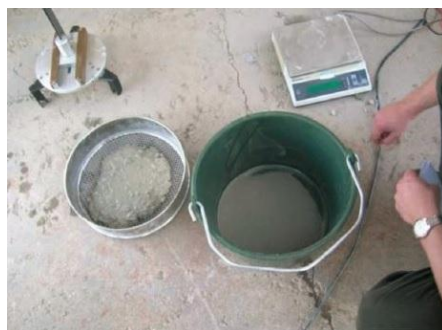
Рис. 4. Определение устойчивости к расслоению СУБ с помощью сита
