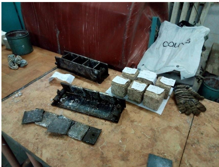
Рис. 3. Образцы гипсового костробетона после расформования
