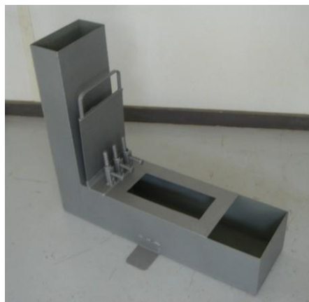
Рис. 3. Определение проходимости СУБ в L-образном ящике
