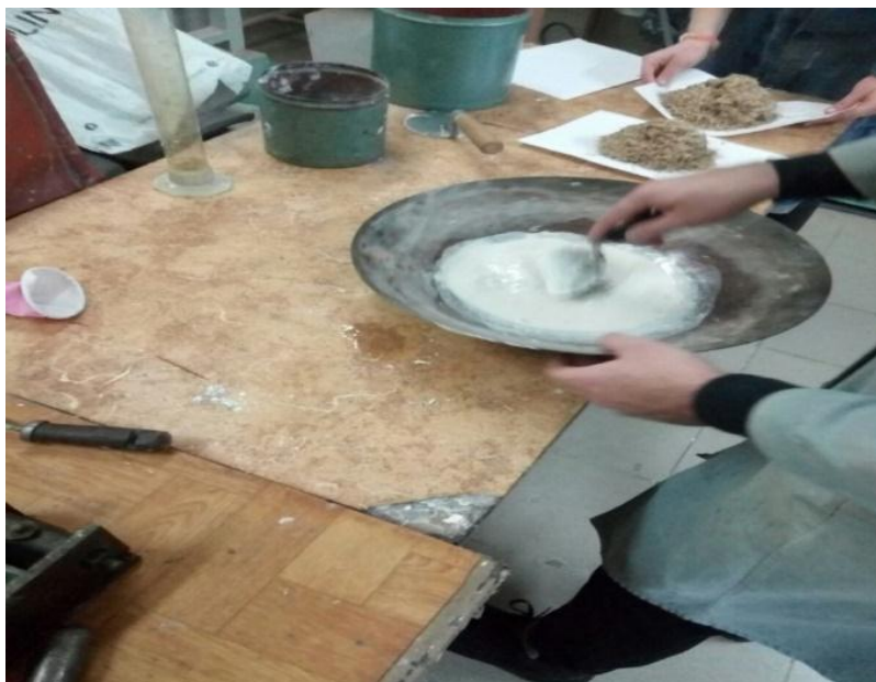
Рис. 2. Приготовление формовочной массы гипсового костробетона
