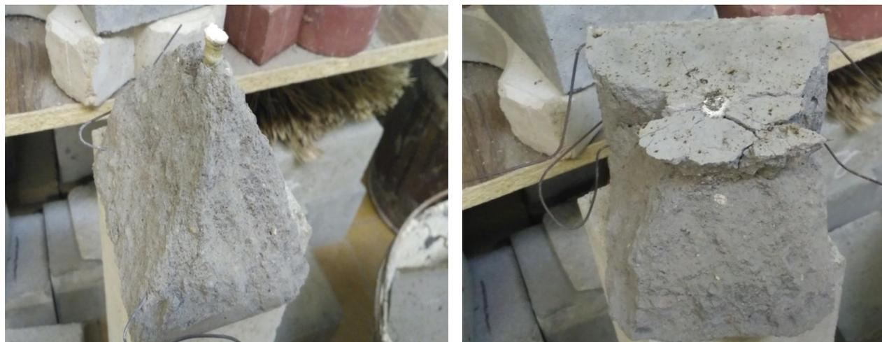
Рис. 1. Образец со стеклопластиковой арматурой после испытаний на прочность
