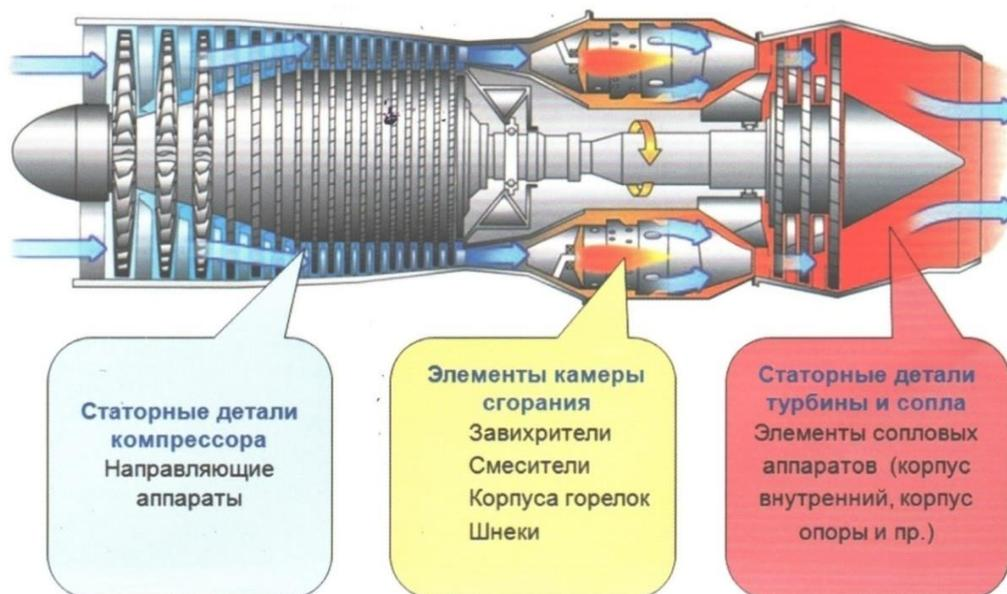
Рис. 2. Газотурбинный двигатель
